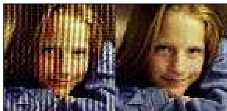
A bal oldali ábrarészlet amplitúdómodulált (AM), a jobb oldali frekvenciamodulált (FM) ráccsal készített kép
